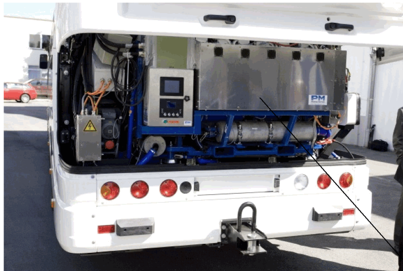
Installiertes Brennstoffzellensystem im Heck des TriHy Busses
