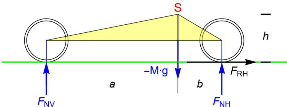
Die Normalkräfte  $F_{NH}$  und  $F_{NV}$  ergeben sich aus der Kräftebilanz in  $y$ -Richtung und aus dem Drehimpulssatz bezüglich Schwerpunkt  $S$  ohne Beschleunigung und Reibung zu
