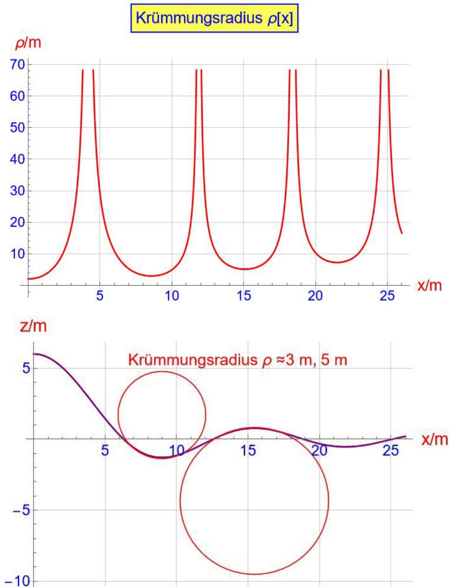
Im vorliegenden Fall mit  $M = 80$  kg,  $v = 15$  km/h und  $\rho \approx 3$  m bez.  $\rho \approx 5$  m  $\blacktriangleright$   $F_Z \sim 450$  N bez.  $F_Z \sim 270$  N.
