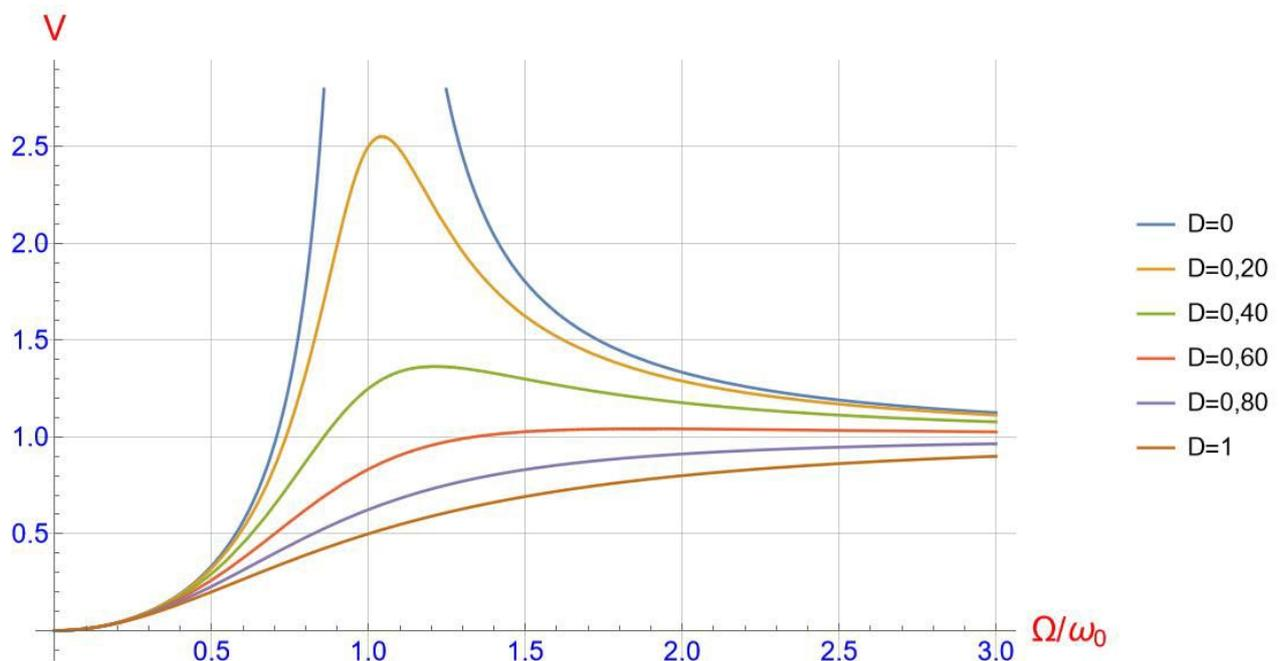
Als Verlauf von  $V$  in Abhängigkeit der Dämpfung  $D$  ergeben sich die obigen Kurven:
