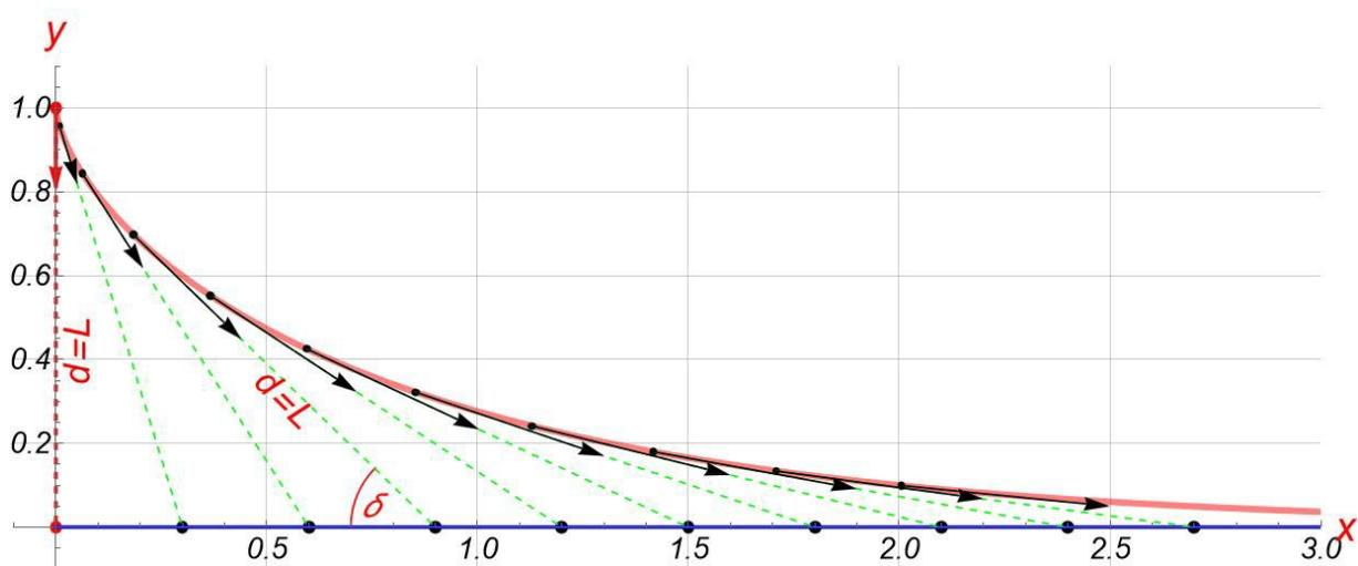
Zur Abbildung: Bei  $(0, d)$  hat die Traktrix den höchsten Wert, die Richtung des „Verfolgers“ ( Hinterrad) und die Richtung des „Verfolgten“ (Vorderrad) stehen aufeinander senkrecht ► anfänglicher Lenkeinschlag  $\delta = 90^\circ$ . Der abnehmende
