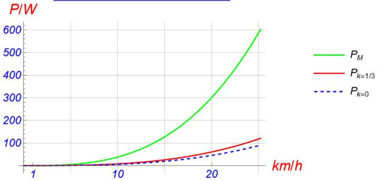
Energie, die bei einer Stunde Fahrt von den Muskeln aufgebracht werden muss als Funktion der Geschwindigkeit
