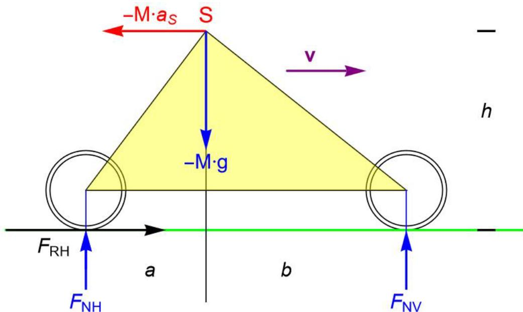
Trägheitskräfte nach d'Alembert sind rot eingezeichnet in entgegengesetzter Beschleunigungsrichtung, die Masse der Räder wird vernachlässigt, das Vorderrad rollt frei. Dynamisches Gleichgewicht und Moment bezüglich Schwerpunkt S :
