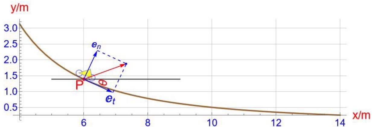
Bestimmen Sie die Beschleunigung in Richtung der Normalen der Bahn, die resultierende Beschleunigung und die Normalkraft der Räder auf die Bahn (Gesamtmasse  $M = 100 \text{ kg}$ )
