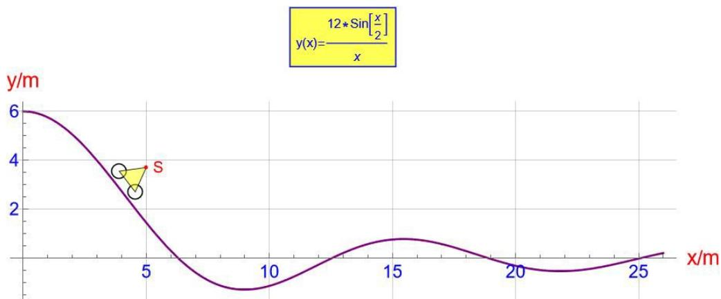
es wird von einer Fahrt mit vernachlässigbarer Reibung unter der Schwerkraft  $M \cdot g$  ausgegangen. Mit Reibung muss die Lagrange-gleichung um eine Dissipationsfunktion  $P$  erweitert werden (siehe <sup>(3)</sup> am Schluss). Die Lösung der Lagrange-gleichung führt auf eine Differentialgleichung  $f(\ddot{x}(t), \dot{x}(t), \dots)$ , deren Lösung  $x(t)$ ,  $y(t)$ ,  $v(t)$  usw. ergibt.
