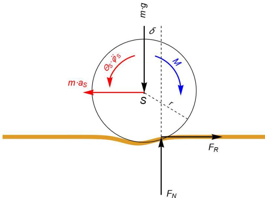
Das Rad wird mit dem Drehmoment  $M$  angetrieben. Nach dem Freikörperbild ergeben sich die folgenden Dynamischen Gleichgewichtsbedingungen:
