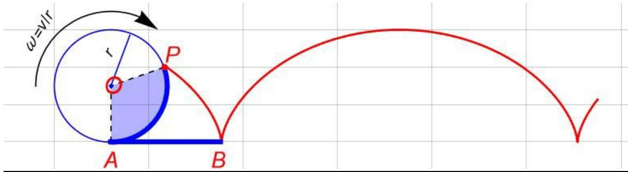
Der Winkel A-O-P ist der „Wälzungswinkel“, um den sich das rollende Rad dreht und dessen dazugehöriger Radumfang auf der Strecke A-B abrollt. Die Spitzen liegen bei  $(2 \cdot k \cdot \pi \cdot r, 0)$ ,  $k = 1, 2, \dots$ , die Scheitelpunkte bei  $[(2 \cdot k + 1) \cdot \pi \cdot r, 2 \cdot r]$ .
