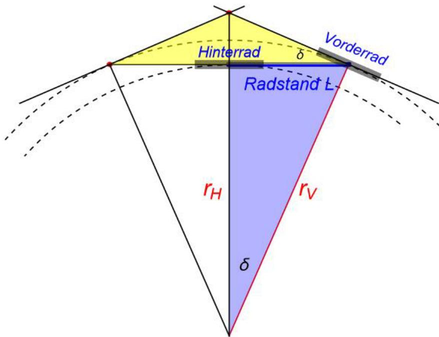
Der Lenkeinschlagwinkel (Drehwinkel der Lenkstange) ergibt sich nach der Abbildung zu
