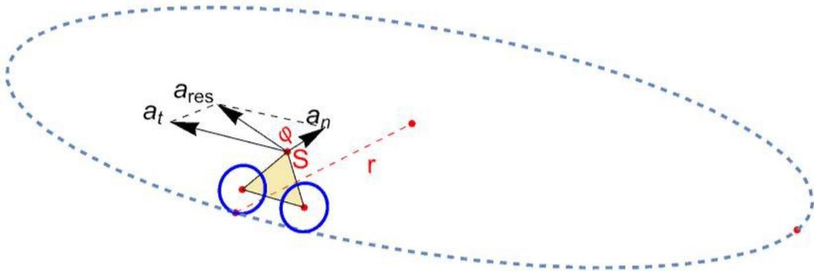
$$v = v_0 + a_t \cdot t \rightarrow a_t = \frac{(125/18) \cdot \frac{\text{m}}{\text{s}}}{20 \cdot \text{s}} \approx 0,35 \frac{\text{m}}{\text{s}^2}$$
