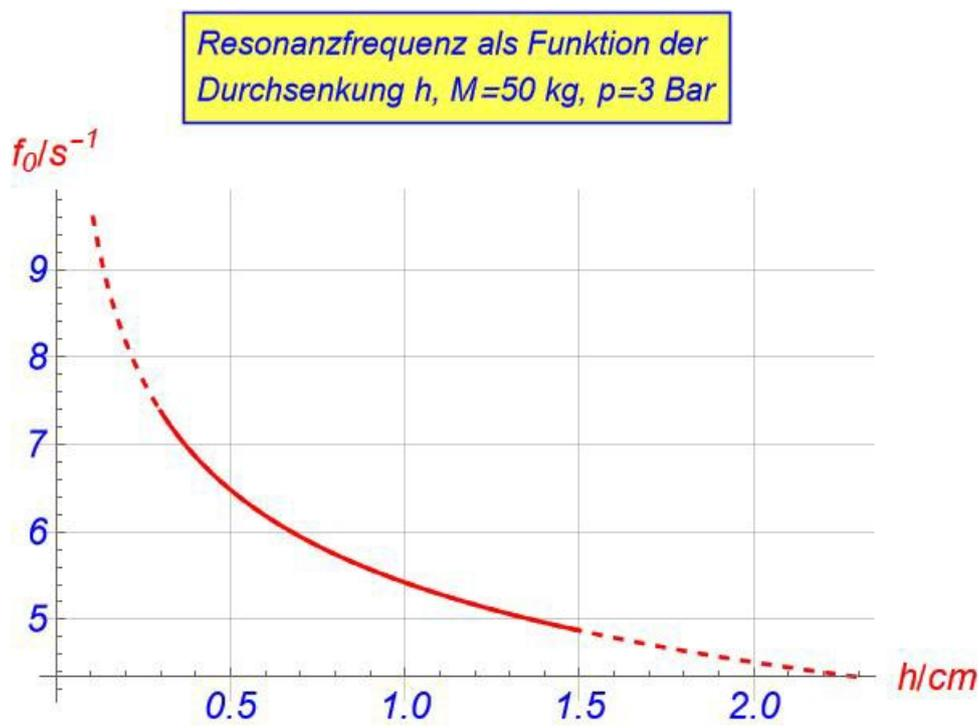
Wird der Reifen z.B. durch Kopfsteinpflaster oder ähnliches mit der Resonanzfrequenz angeregt, entstehen extreme Vibrationen.
