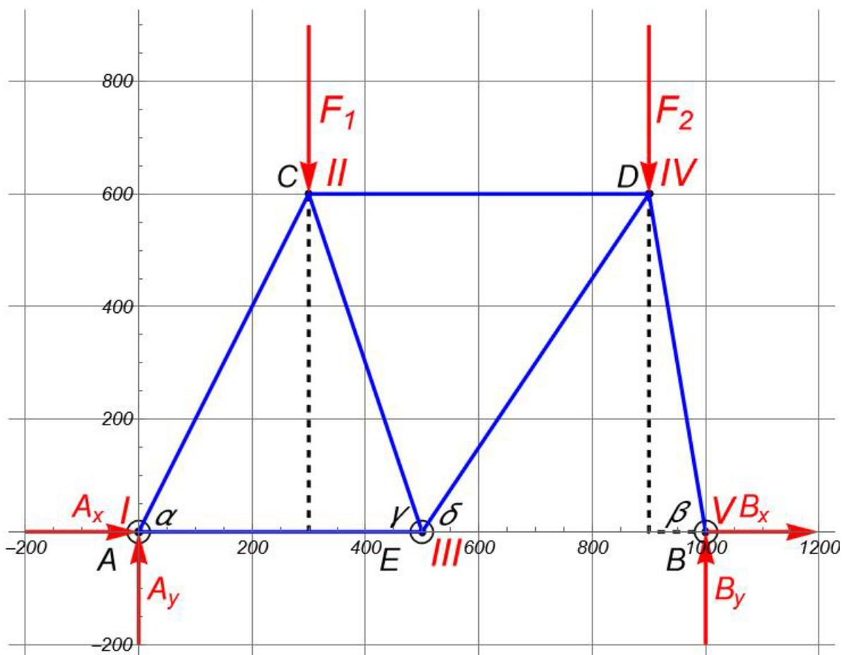
Aus den Maßen der Skizze (mm) entnimmt man die Hebelarme und Winkel und daraus die Stabkräfte. Für verschiedene Anordnungen der Stäbe lassen sich die Stabkräfte berechnen und danach entscheiden, ob bestimmte Materialien für die jeweilige Beanspruchung geeignet sind.
