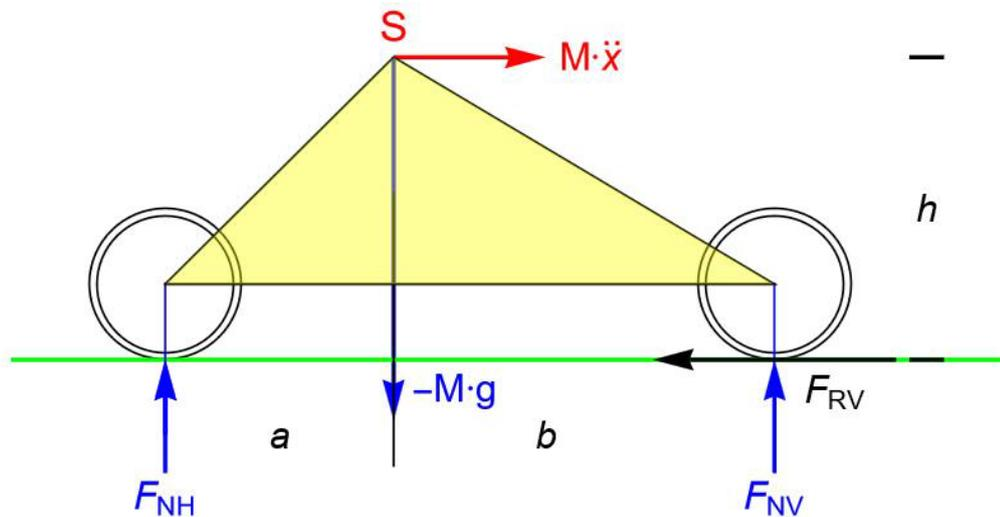
Die Summe der Kräfte in  $x$  und  $y$ -Richtung und die Momentengleichung bezüglich des Auflagepunktes des Vorderrades ergibt das folgende Gleichungssystem (rot ist nach d'Alembert die Trägheitskraft, das Hinterrad ist bereits unbelastet  $F_{NH} = 0$ )
