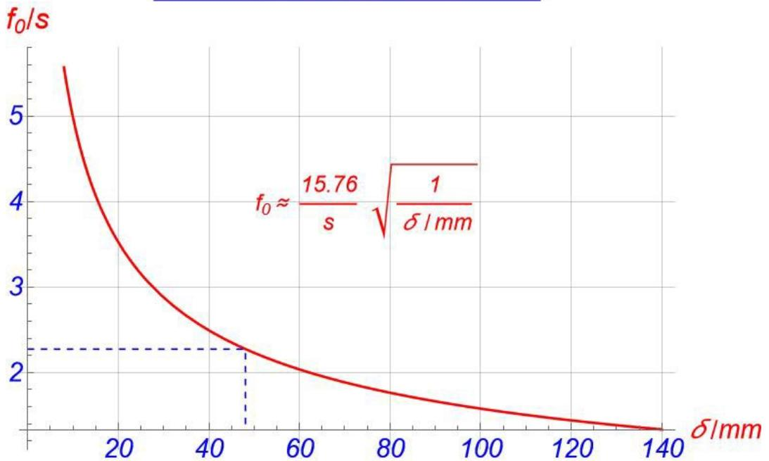
Die Formel in der Abbildung bedeutet: ein schwerer Fahrer bewirkt bei demselben Rad eine niedrigere Resonanzfrequenz wegen der größeren Stauchung, als ein leichter Fahrer.
