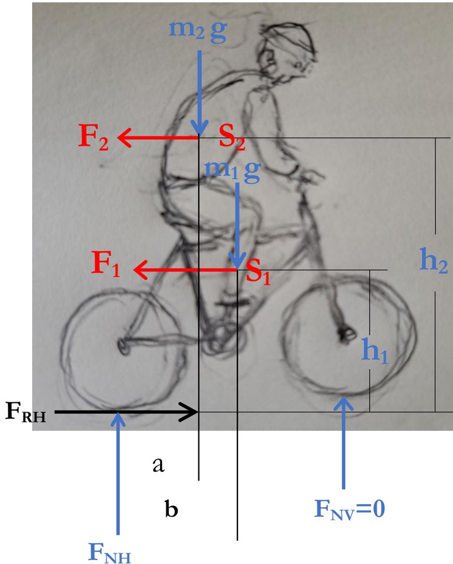
Die Masse vom Rad beziehungsweise Fahrer beträgt  $m_1$  und  $m_2$ , der jeweilige Schwerpunkt  $S_1$  und  $S_2$ , die Räder sollen masselos sein. Bei der Startbeschleunigung spritzen Sand und Steine vom Hinterrad nach hinten, das heißt der Boden muss die
