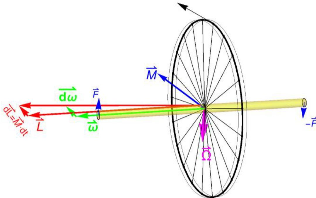
Versuch: Man nimmt das Vorderrad und kippt es nach Abbildung mit  $F$  und  $-F$  mit dem Drehmoment  $M = 2 \cdot l_{\text{Stange}} \cdot F$ , das Rad weicht nach rechts mit einer Präzessionsfrequenz aus, es gilt mit dem Einheitsvektor  $\vec{e}_\omega$  in Richtung  $\vec{\omega}$
