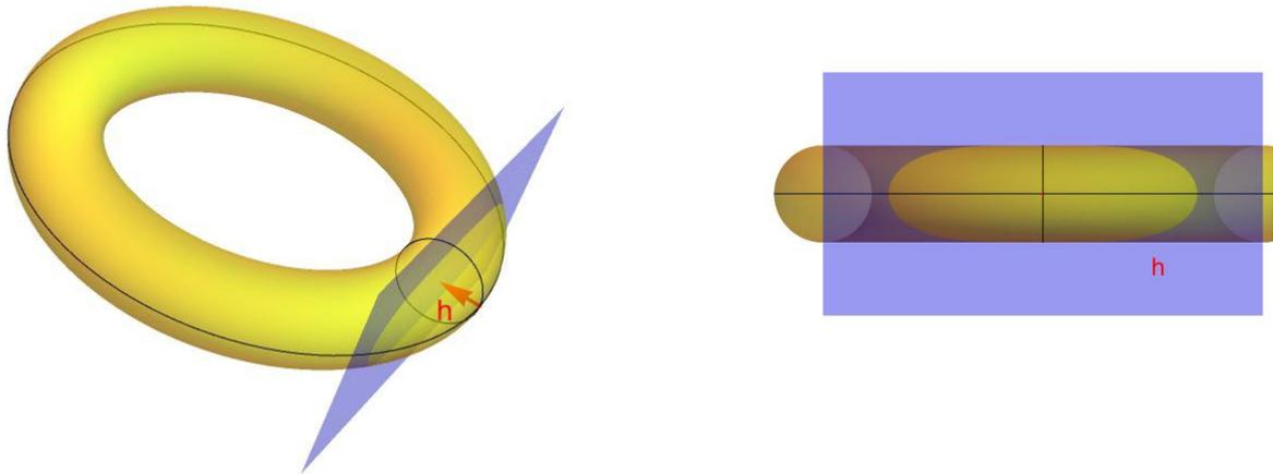
Wird der Reifen auf dem Boden samt Felge impulsförmig angeregt, entsteht eine gedämpfte Schwingung, die zeitlich nach einer e-Funktion abklingt. Eine charakteristische Größe ist wie im vorherigen Fall die Resonanzfrequenz  $f_0$  des schwingenden Systems, sie ergibt sich näherungsweise folgendermaßen:
