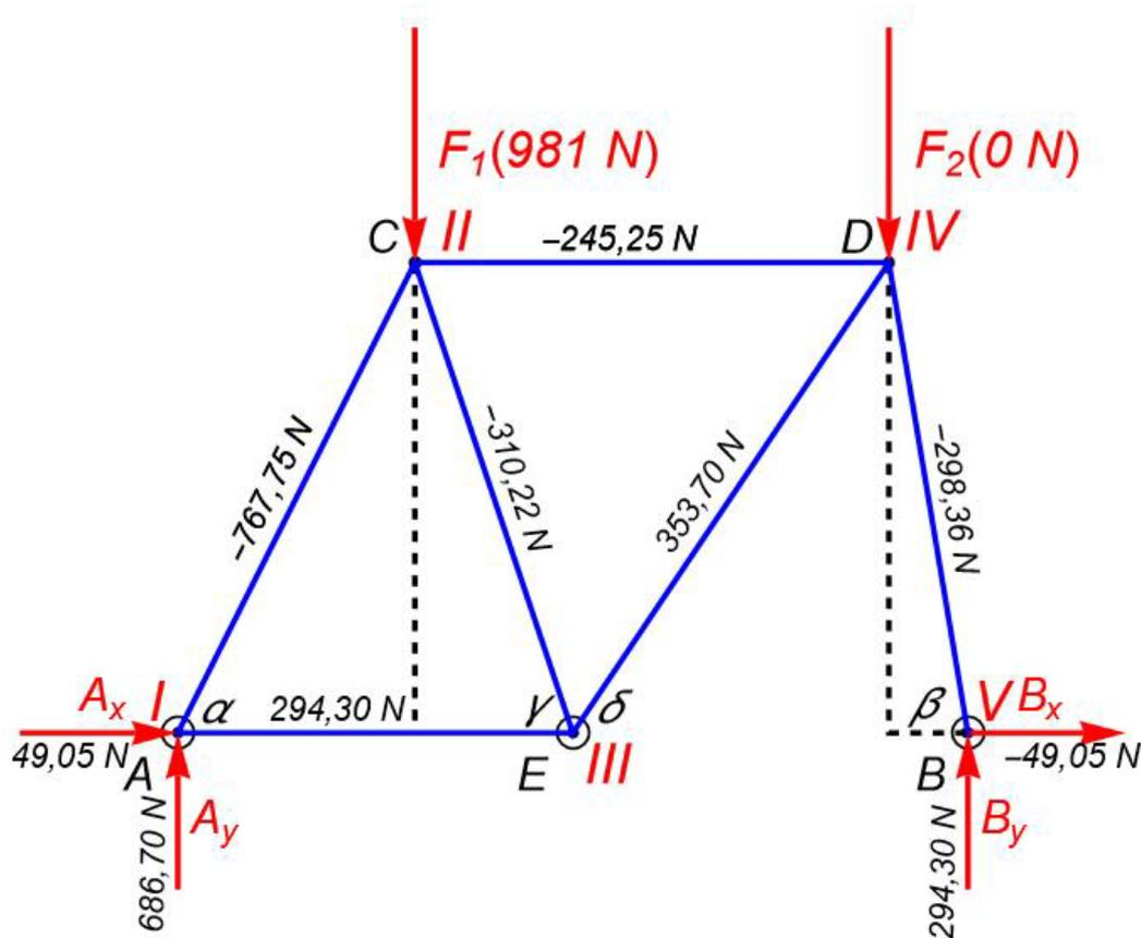
Die Belastung der Rahmenteile und Auflagerkräfte ändert sich, wenn Kraft auf die Lenkstange ausgeübt wird. Als Beispiel soll der Sattel mit 70 % des Gewichts und die Lenkstange mit 30 % des Gewichts belastet werden. Als Ergebnis bekommt man dann
