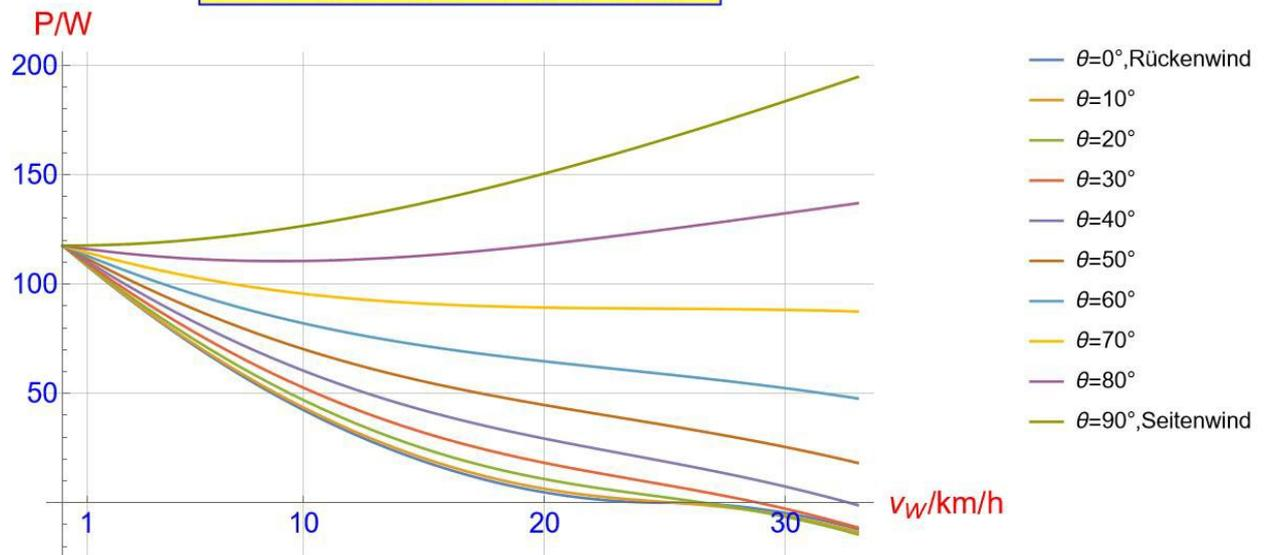
Nullstellen für die Leistung  $P$  ergeben sich, wenn die Projektion der Windgeschwindigkeit in Fahrtrichtung gleich wird der Fahrgeschwindigkeit.
