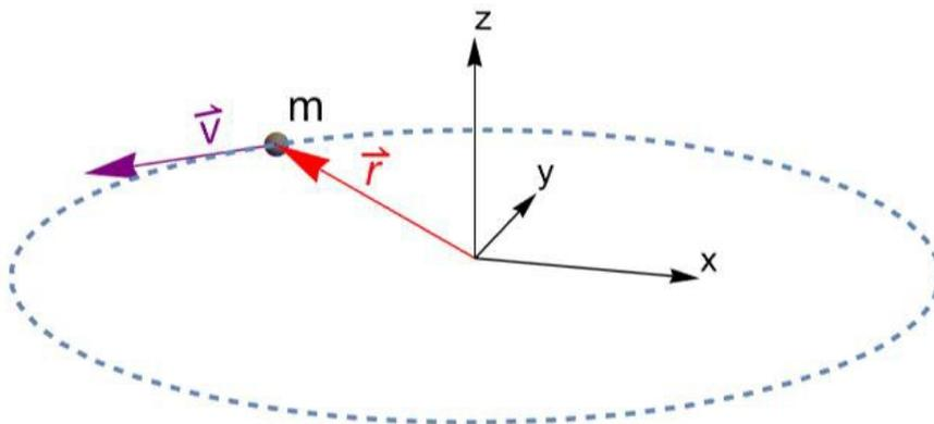
Nach Abbildung führt die Masse  $m = 0,2 \text{ kg}$  eine Kreisbewegung mit dem Radius  $r = 1 \text{ m}$  und der Geschwindigkeit  $0,2 \text{ m/s}$  aus. Bestimmen Sie vektoriell den Drehimpuls  $L$  mit Richtung und Betrag.
