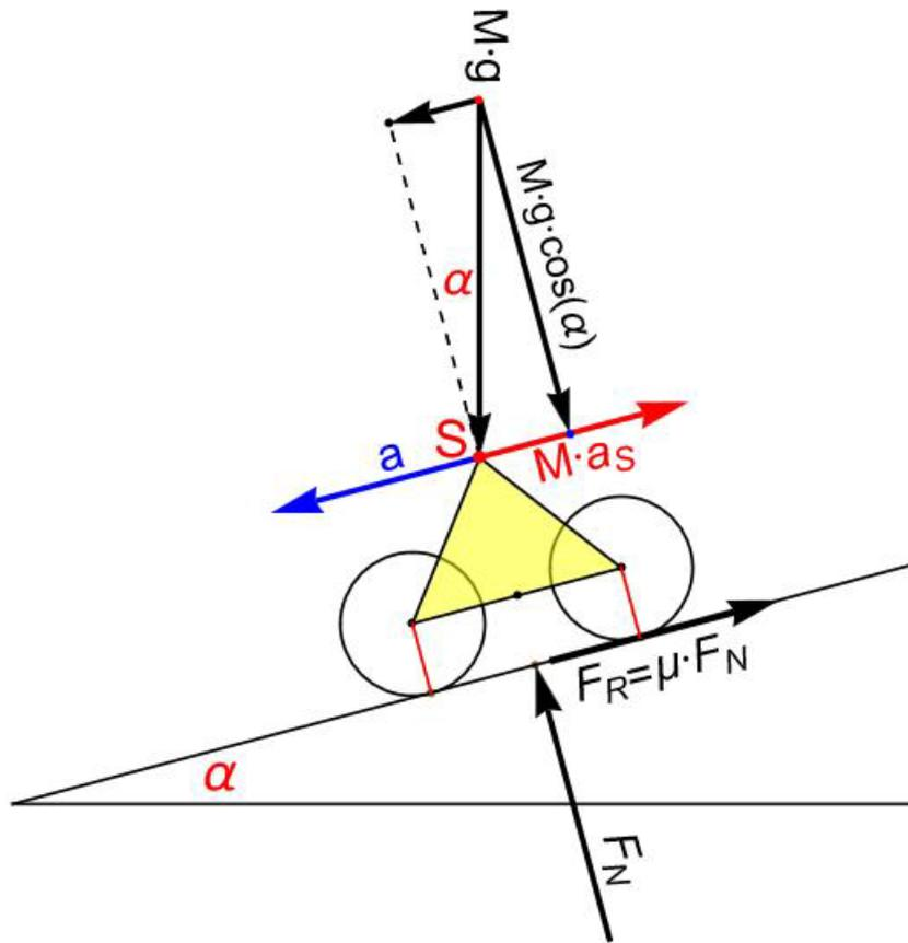
Danach wird die Trägheitskraft  $M \cdot a_s$  entgegen der Beschleunigung  $a$  rot eingetragen und das Kräftegleichgewicht in Richtung der schiefen Ebene (Index  $s$ ) und senkrecht dazu ( $n$ ) berechnet:
