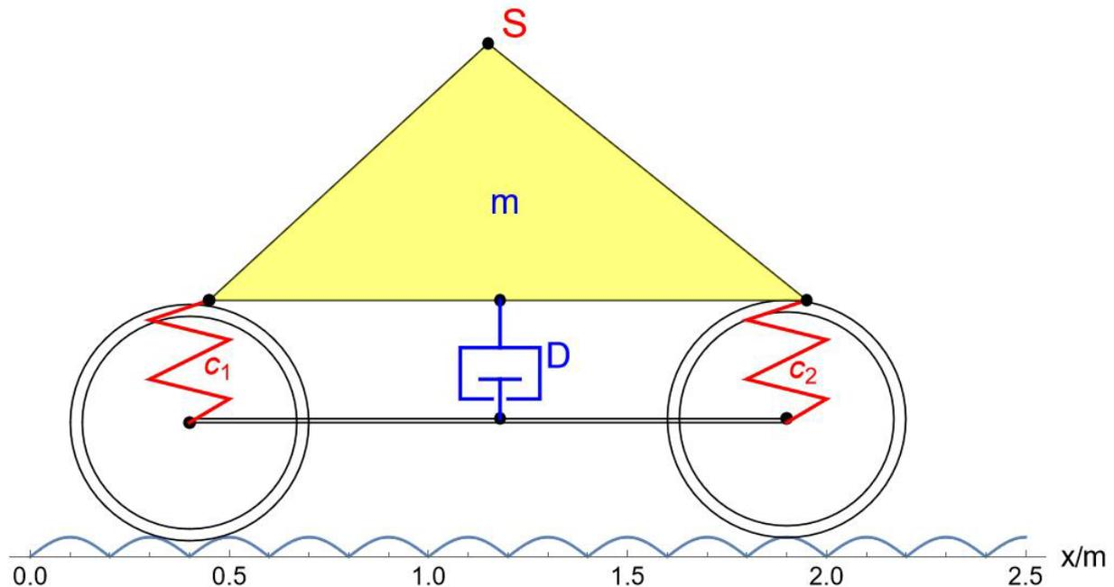
Ist die Krafteinleitung periodisch, erhält man eine erzwungene gedämpfte Schwingung, die durch die Differentialgleichung
