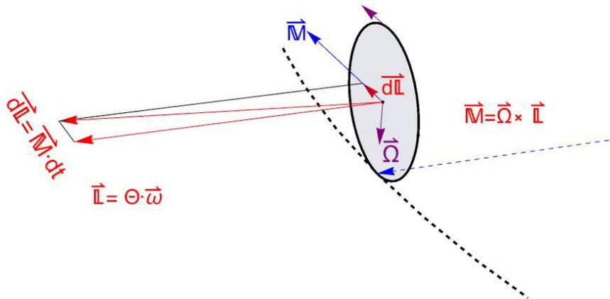
Auf die rotierenden Räder wirken Kreiselkräfte („geführter Kreisel“), sie haben einen Drehimpuls in Richtung der Achse (Abb.) von
