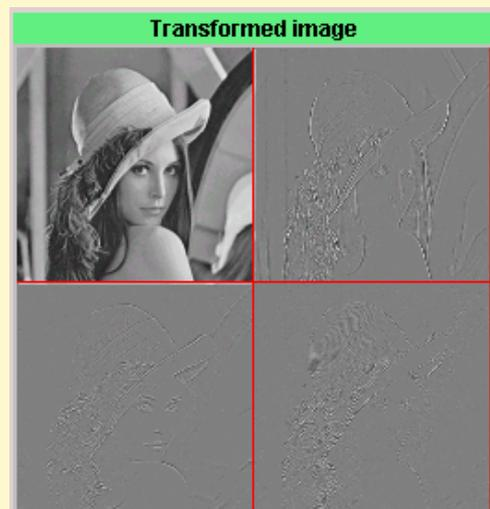
2. Stufe: spaltenweise Zerlegung
