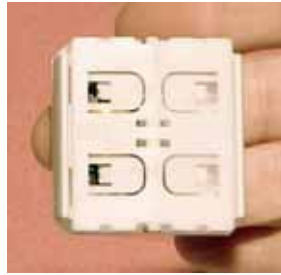
Abb. 2-3: Kabelloser und batterieloser Schalter (EnOcean).
